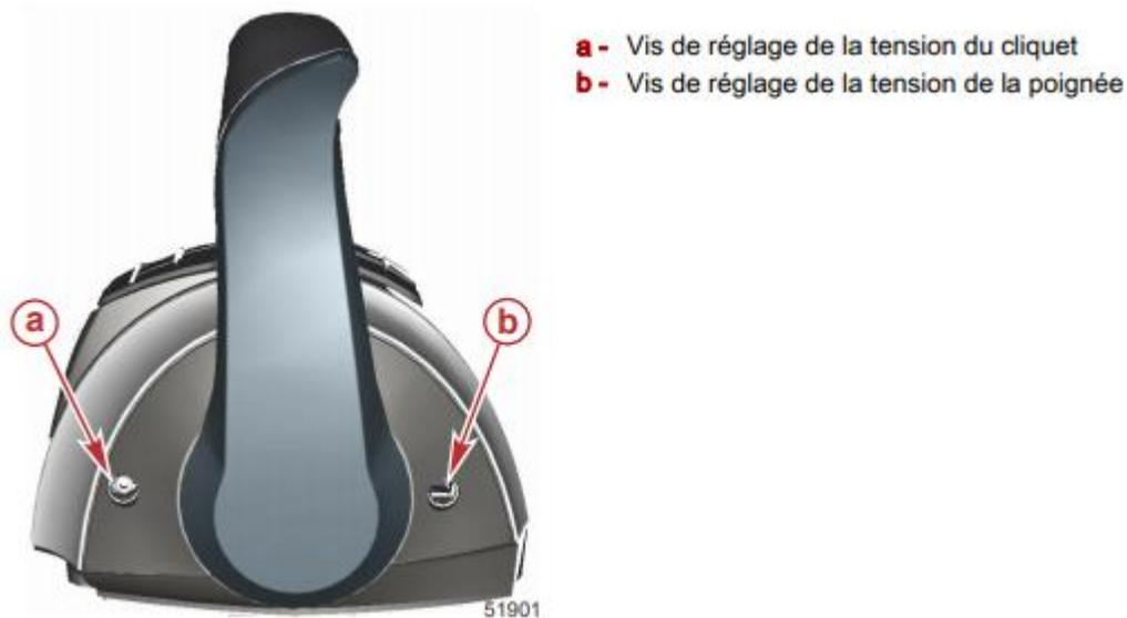
Vis de réglage de la tension du cliquet – Cette vis peut être réglée pour augmenter ou réduire l'effort nécessaire pour sortir la poignée de commande des différentes positions de cliquet. Visser dans le sens horaire pour augmenter la tension.
