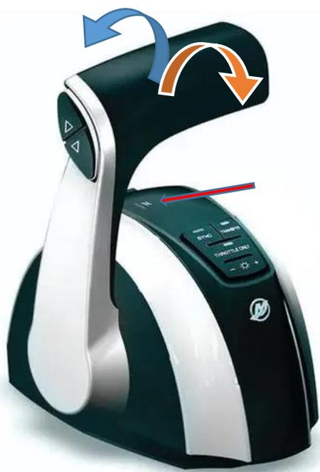
Là aussi, contrairement aux manettes mécaniques où il est nécessaire d'actionner un bouton sous la poignée pour quitter le point mort vers la position « marche avant » ou « marche arrière », les **manettes électroniques ou numériques sont dépourvus de système de blocage** et, comme pour les voitures automatiques, **un simple cliquet** est à passer pour enclencher la propulsion et un **voyant « Neutral »** indiquant s'il on est au point mort au non.
