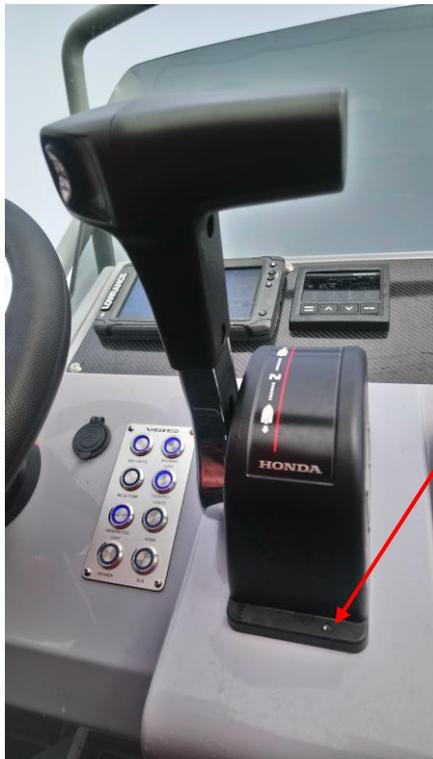
Contrairement aux manettes mécaniques où il est nécessaire d'actionner un bouton sous la poignée pour quitter le point mort, ici il suffit simplement de basculer la poignée vers l'avant l'arrière pour enclencher la vitesse.
